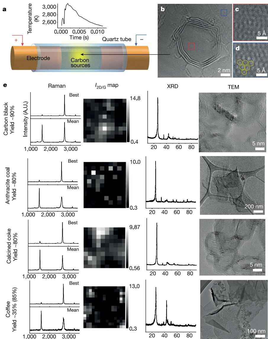
**图1：由各种碳源合成的FG。** a. FJH过程的示意图
